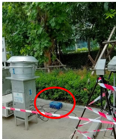
รูปที่ 3.21 การตรวจวัดความสั่นสะเทือน จุดที่ 2 โรงพยาบาลราชพฤกษ์
